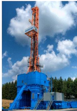
DS 10 Bentec 350 t hook load
