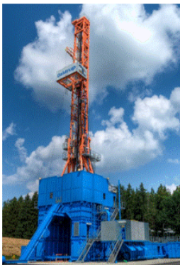
DS 10 Bentec 350 t hook load
