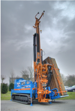
DS 10 Bentec 350 t hook load
