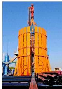
DS 20 Drillmec 272 t Hakenlast
