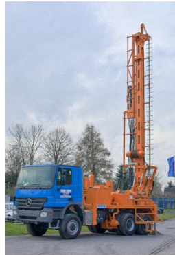
DS 20 Drillmec 272 t Hakenlast
